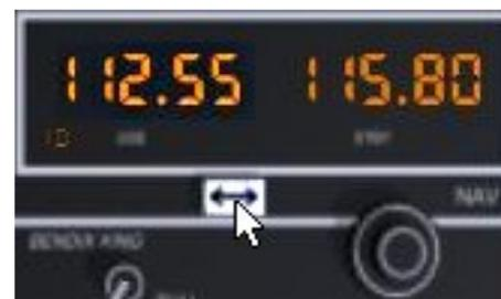
Vous réglez votre fréquence en attente à l'aide de la souris et du bouton de réglage, puis pour utiliser cette fréquence vous basculez la fréquence en active à l'aide du commutateur (double flèches).
