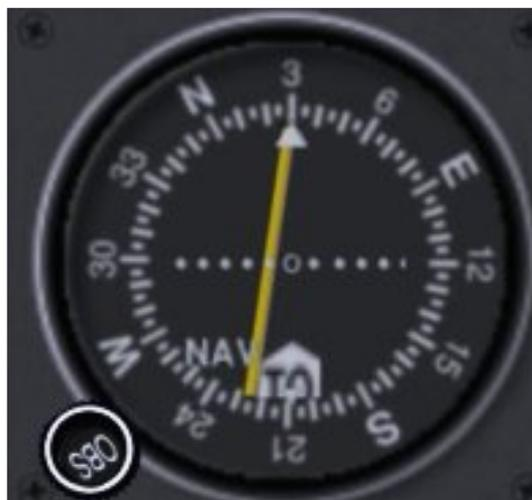
Ces Indicateurs gyroscopiques ont un bouton rotatif en bas à gauche, le sélecteur de réperage de cap OBS.
