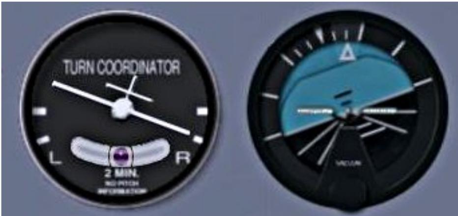
Exemple d'un virage à droite (90°), remarquez la position de la ligne d'horizon sur l'Horizon artificiel par rapport à l'appareil. L'indicateur de virage affiche un virage à droite (R) et la bille (violette) est parfaitement centrée indiquant un virage stabilisé.
