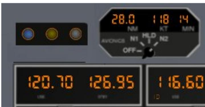
Le commutateur DME permet de sélectionner NAV1 ou NAV2 pour afficher les informations correspondantes, la distance (en Mile Nautique), la vitesse au sol (en Noeuds) et le temps restant (en Minutes) jusqu'à la station VOR.
