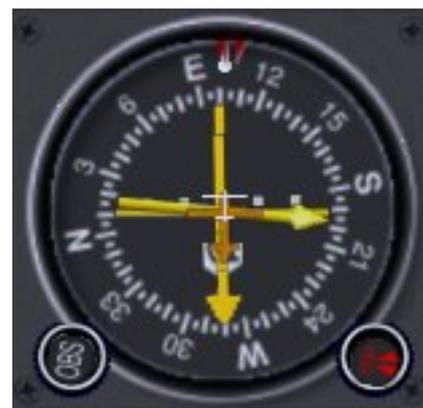
L' ILS se compose de plusieurs systèmes émetteurs, de faisceau de descente (Glide Slope), de cap d'atterrissage (Localizer) . Bien évidemment, à bord de l'appareil, l'ILS à besoin des récepteurs capables d'intercepter les signaux de ces émetteurs :
