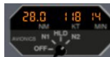
Vous régler le récepteur NAV (ici NAV2) sur la fréquence VOR 116.80, vous basculer le commutateur DME sur le NAV correspondant (ici N2): La distance vers la Tour de KOAK s'affiche (ici 28 NM) et l'indicateur VOR (compas) affiche que l'appareil se dirige (TO) au cap 30.
