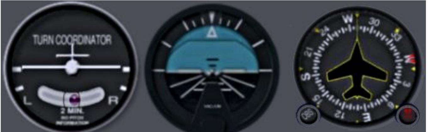
L'indicateur de virage, l'horizon artificiel et le conservateur de cap font partie des instruments gyroscopiques.
