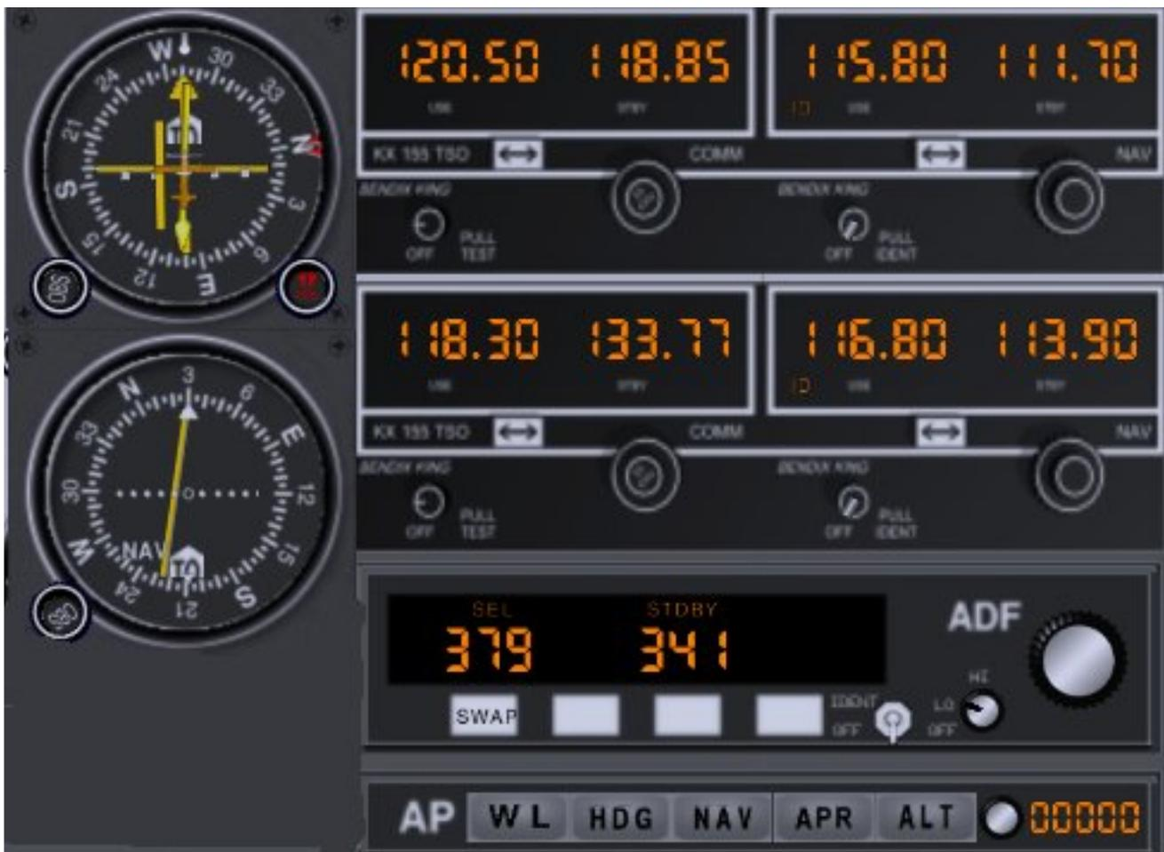
ADF, VOR, COMM, NAV, Auto Pilote et Transpondeur font partie des instruments radio de navigation.
