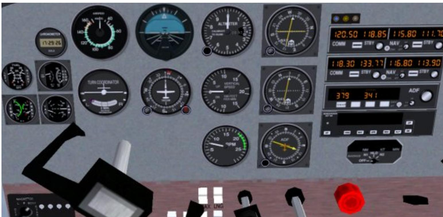
Le tableau de bord se compose de différents manomètres, instruments gyroscopiques et de navigation. Ces jauges et instruments affichent des informations sur les pressions, l'altitude, la vitesse, la position, le cap... etc. Avec une gouverne de direction (manche) et des manettes pour les gaz et les volets.
