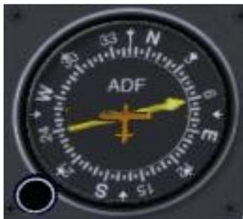
Le RMI à une aiguille est certainement le plus lisible de ces quatre indicateurs, il affiche directement, après avoir positionné le cadran tournant sur le cap (345° par exemple), la radiale et la position magnétique de la balise; C'est un compas gyroskopique.
