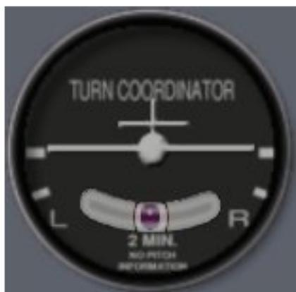
L'indicateur de virage indique le taux du virage en cours et la qualité du virage avec la bille (violette). Si cette bille reste centrée pendant un virage à gauche (L) ou à droite (R) ce virage est correct (équilibré) sinon il y a glissement (dérapage) et le virage n'est pas stabilisé.
