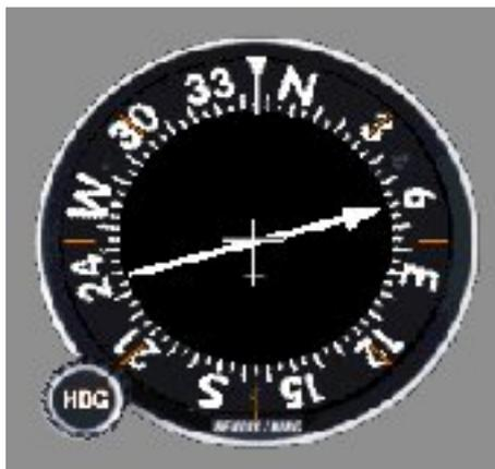
Avec ce type de compas à cadran tournant il est possible de positionner le cadran sur le cap 345° et alors la position magnétique de la balise 60° est directement indiquée par l'aiguille.
