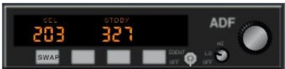
Sur le receptrer NDB ADF, avec le bouton à l'extrême droite, vous régler les fréquences NDB= 203 et 327 (en attente) de KSJC ou 203, un NDB se situant entre KSFO et KSCJ.
